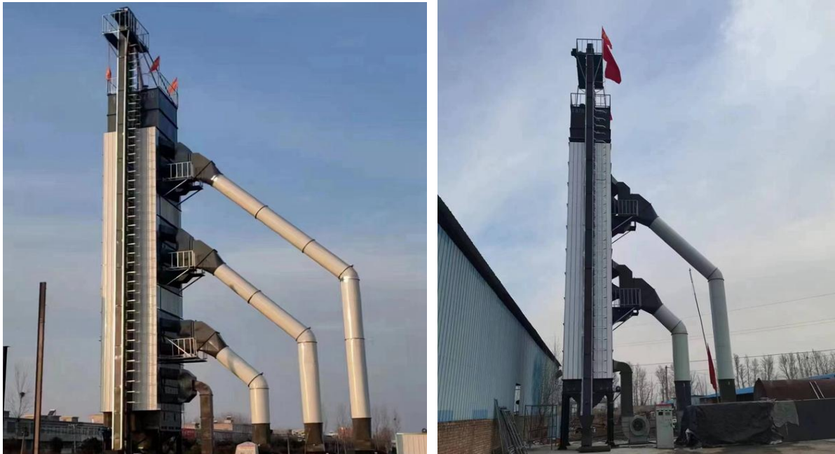
图 5-1 粮食烘干设备示意图
