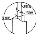
出屋面管道伴热带及保温安装图
