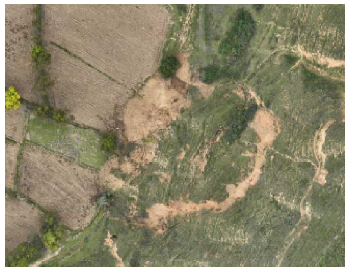
西堡灌区（东干渠寺尔寨段山体滑坡渠道掩埋）
