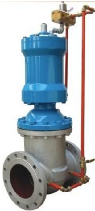
④智能调节闸阀：集成流量/压力传感器与 PID 调节模块，可实现开度精准控制（调节精度 \pm 1\% ）；支持与云平台实时通讯，自动根据管网工况调整开度，但初始成本较高。
