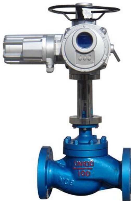
④智能调节闸阀：集成流量/压力传感器与 PID 调节模块，可实现开度精准控制（调节精度 \pm 1\% ）；支持与云平台实时通讯，自动根据管网工况调整开度，但初始成本较高。
